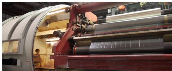
a fémzési folyamatra alkalmas berendezés zárt vákuum kamra (a művelet befejezése után nyitott állapotban)
