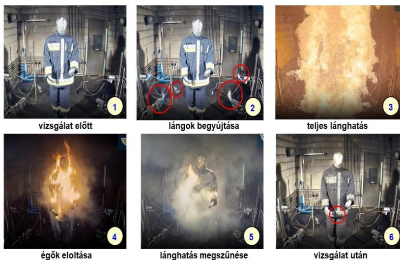
10. ábra. BTGG égetési teszt szenzoros próbabábún (120 s)
