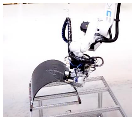
14. ábra. 3D varrástechnika alkalmazása egy hengeres alakú alkatrész külső és belső felületén (Pfaff) [13]
