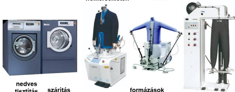
9. ábra. A nedves tisztítási folyamat főbb műveletei
