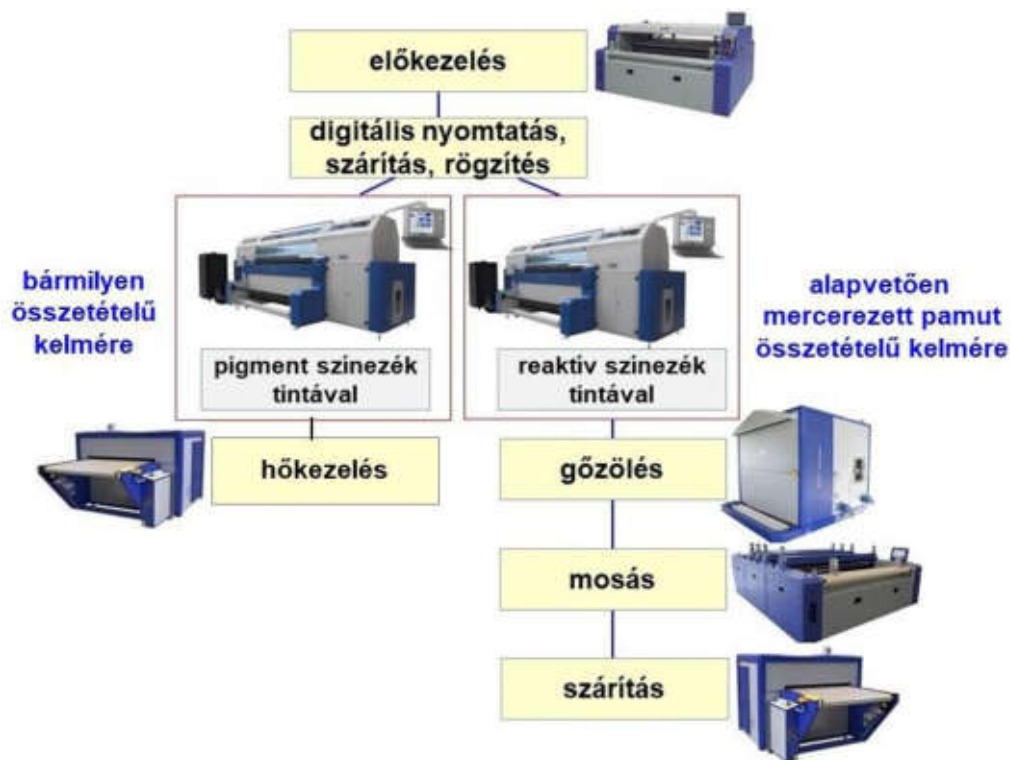
35. ábra Digitális textilmintázás utáni színezékrögzítési műveletek
