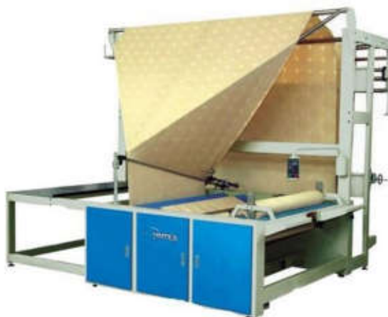
kiszírelés kettőzve (duplázva) tekercsképzéssel
