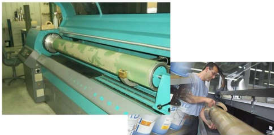
49. ábra Lézeres mintakialakítás rotációs sabloncsövön
