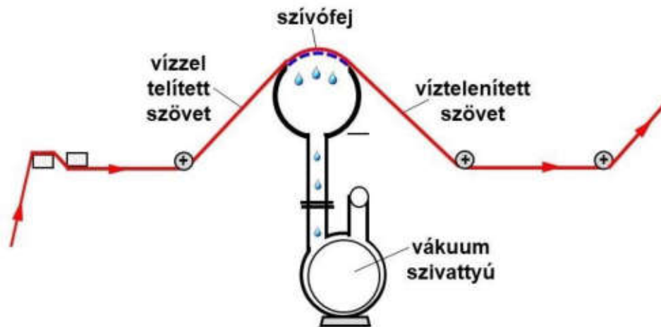
8. ábra A vákuumszívógép működése
