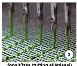
A műfűgyártás menete 6. ábra
