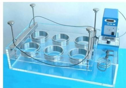
vízgőzzel szembeni ellenállás meghatározása
