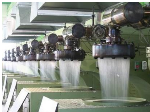
3. ábra. A poliamidszál gyártása a polimer ömledékből
