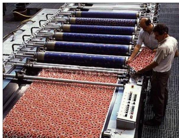
10. kép. A rotációs filmnyomógép működés közben
