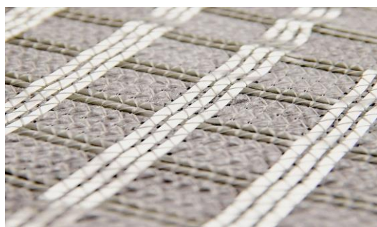
7. ábra. Polipropilén alapanyagú geotextiliára felvart üveg- vagy bazaltszál nyalábokból álló kompozit aszfaltreteg megerősítésére
