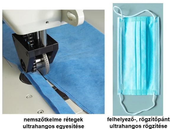
A mechanikus rezgetéssel és nyomással történő egyesítő eljárásokra példák
