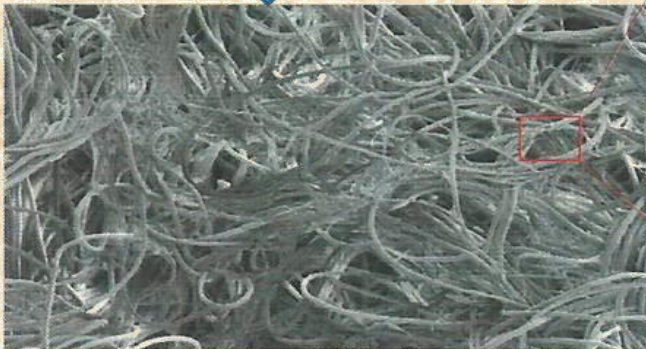
Vízugárral kuszált és szétbomlott szálak
