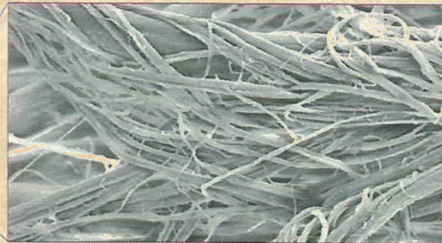
A végeredmény: szétbontott, kb. 500 nm vastagságú elemiszálak
