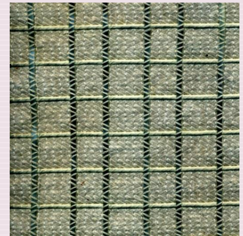
Kompozit textília útburkolat alapozásának megerősítésére
