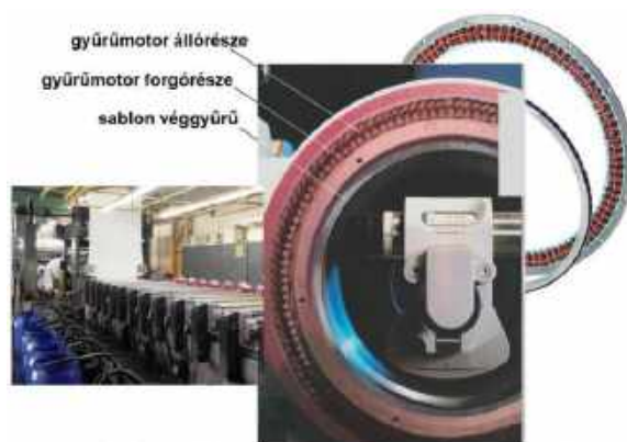
„Direct Drive” sablonhajtás gyűrűmotorral a rotációs filmnyomógépen
