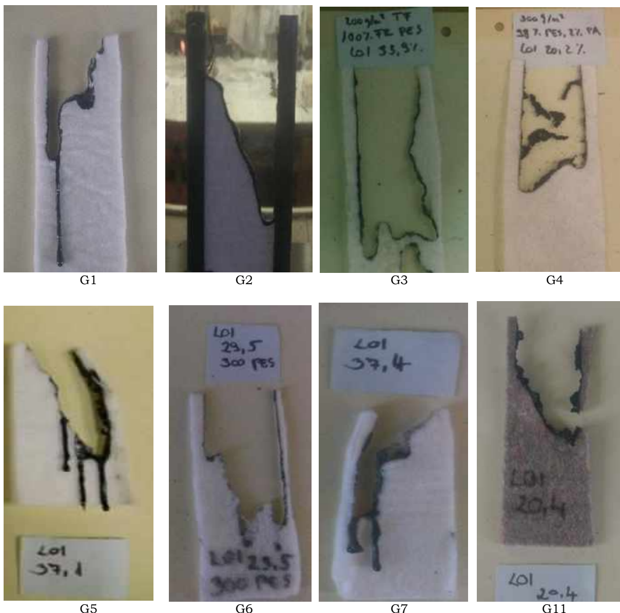
7. kép. Minta károsodása különböző oxigéntartalomban égetve
