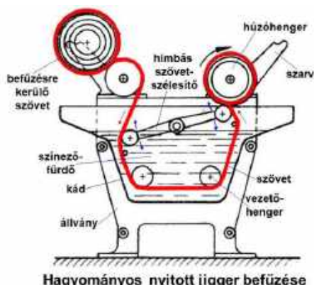
Hagyományos nyitott jigger befűzése 10. ábra
