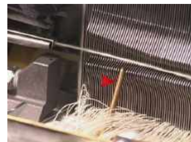
9. ábra. Kúpos kialakítású bordaalagút
