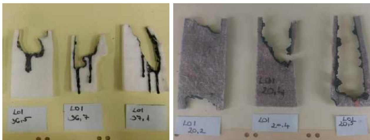
6. kép. A G8 és G11 minta károsodása különböző oxigéntartalomban égetve
