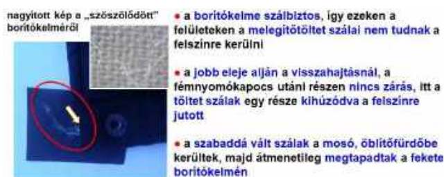
A száلتöltet megjelenése a szálbiztos kelméből készített kabáton
