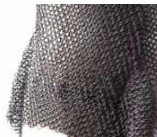
3D nyomtatott elemekből felépülő, sodronyszövet jellegű, visehető ruhadarab
