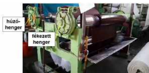
Hagyományos nyitott jigger működés közben 11. ábra
