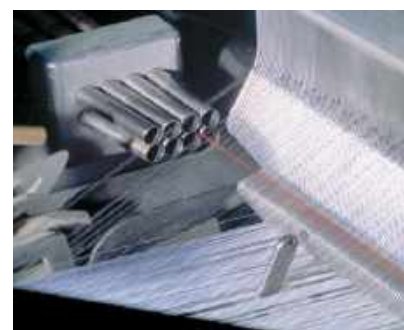
4. ábra. Nyolc szín szövésére alkalmas főfűvóka intenzív légárama veti be a vetüléket
