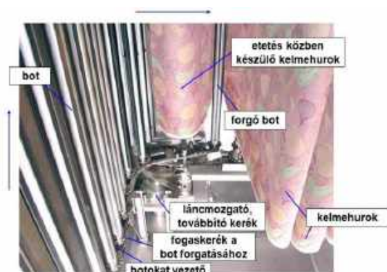
A Festoon (más elnevezéssel: angol, vagy függesztett pályás, ill. botsoros) gőzölő belsejének részlete, alulról fényképezve
