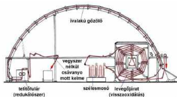
Kétfázisú csávanymás kifejlesztő-gépsora ívalakú gőzölővel
