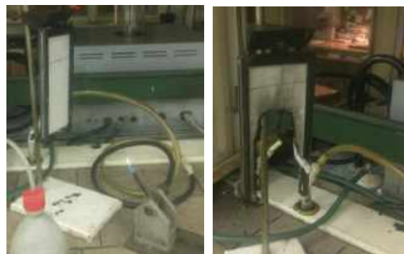
2. kép. A függőleges lángterjedési sebességet vizsgáló berendezés és a minták égése szélgyújtás esetén
