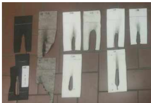
4. kép. A G7–G12 minták károsodása szél- és felületi gyújtás után
