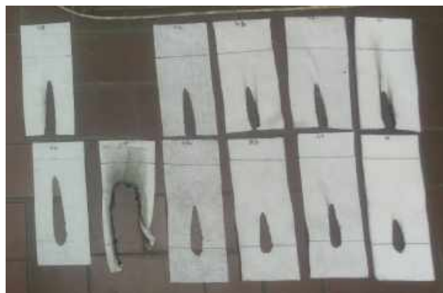
3. kép. A G1–G6 minták károsodása szél- és felületi gyújtás után
