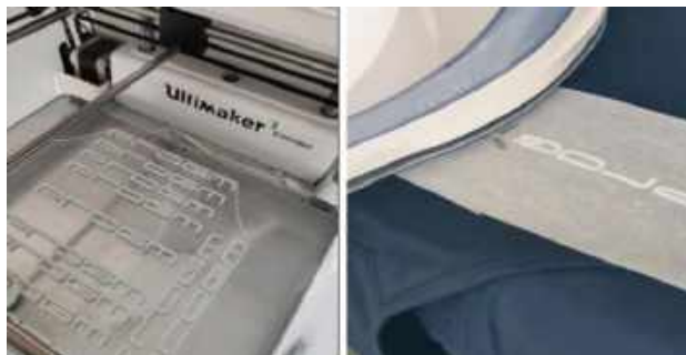
Polókra került logók előállítási módja 3D nyomtatásban, illetve ruhaneműre történő felvitele
