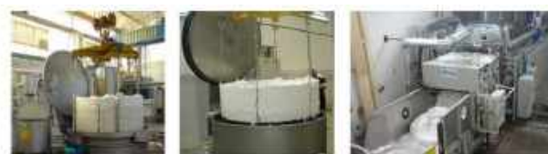
laza szálanyag fehérítése, centrifugálása és szárítása
