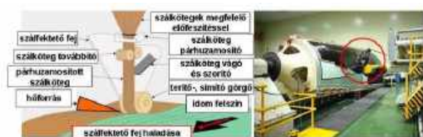
Kompozit vázerősítő szerkezet kialakítására példa a repülőgép gyártásban
