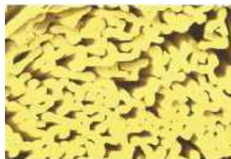
2. ábra. A P84 vegyes szálkeresztmetszetei
