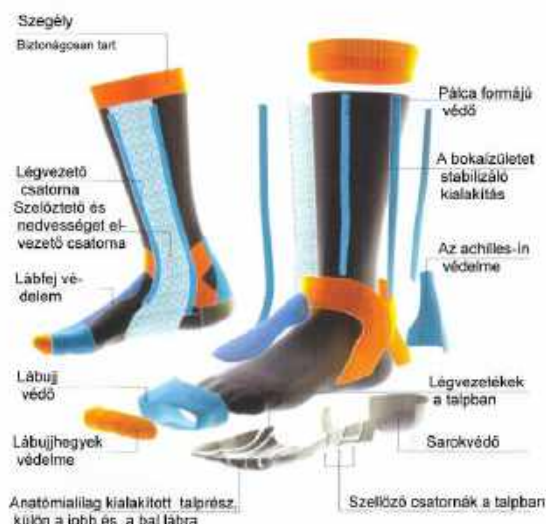
31. ábra. Számos kényelmi, védelmi és támasztó funkciót ellátó sportzokni (X-Socks)
