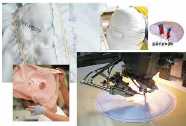
A légszák kialakításának néhány varrási művelete
