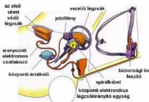
Az egyszerű légzsákrendszer elektromos/elektronikus felépítése
