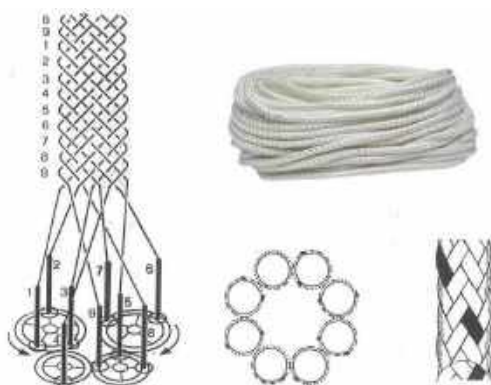
Fonatolt csőzsinór előállítása és szerkezete
