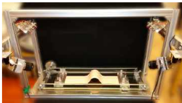
16. ábra. A Sylvie 3D Bending Tester
