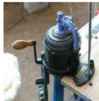
8. ábra. Két tűágyas kézi körkötőgép harisnyaszár készítésére
