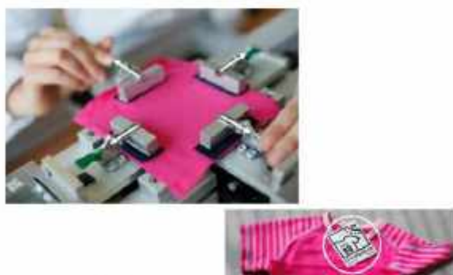
A textilminta feszítése a használatnál bekövetkező megnyúlás imitálására, ami szerkezetritkulással jár
