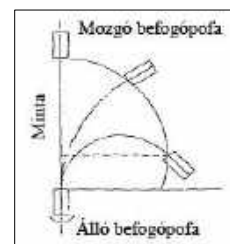
13. ábra. A KES hajlítóvizsgálat elve
