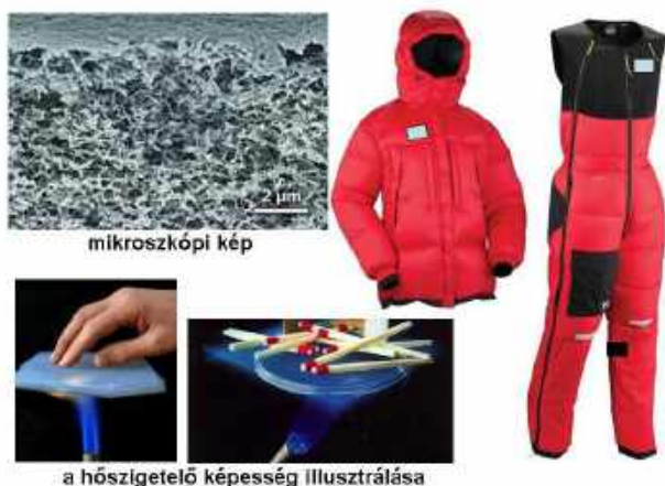
Sportruházat hőszigetelése aerogéllal
