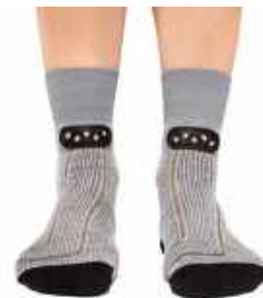
Zokni, amelynek talpában nyomásérzékelők vannak, a bokán pedig információ-továbbító eszköz. Segít olyan futó technikát kialakítani, amely a legjobban kíméli a lábat. (Sensoria)
