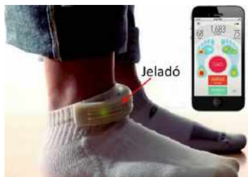
32. ábra. Beépített nyomásérzékelőkkel és jeladóval ellátott zokni, amely mutatja a talpra nehezedő nyomások változásait (Haepsylon)
