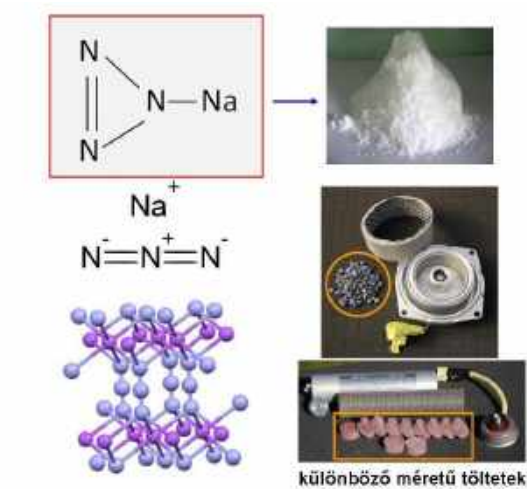
A nátrium-azid a légsák rendszer pirotechnikai eszközében
