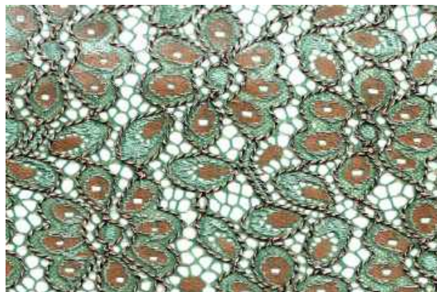
19. ábra. Elektronikus jacquard-mintavezérlésű csipke-raschelgépen készült csipke
