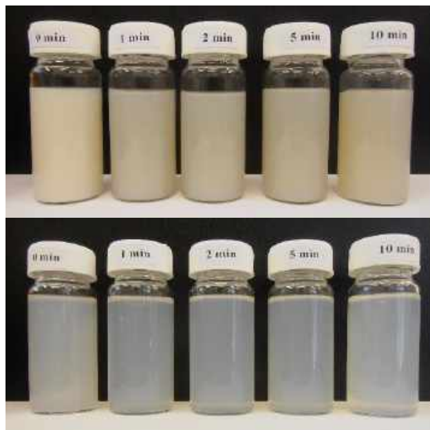
3. ábra. Fehérített pamutból kénsavas hidrolízissel előállított kristályos nanocellulóz szuszpenziók.
