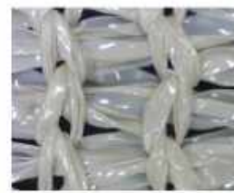
fóliafonalból raschelgépén kialakított mikrohézagos hurkolt kelmé
