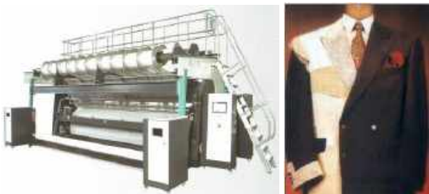
A Karl Mayer Wefttronic HKS gép termékének egyik fontos alkalmazása a ruhaipari közbélés
