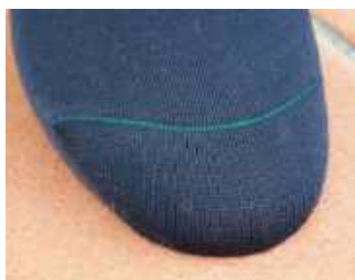
A kötőgépen készített orrhegy-bevarrás (Busi)
