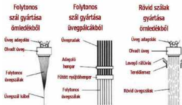
1. ábra. Az üvegszál gyártási eljárásainak elve
