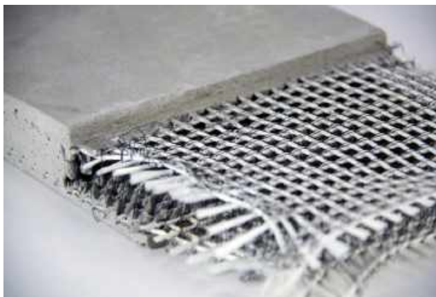
2. ábra. Textilbeton térbeli („3D”) textil-vázszerkezettel
