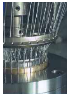
Kör-lánchurkológép 2 fonalvezető gyűrűvel
