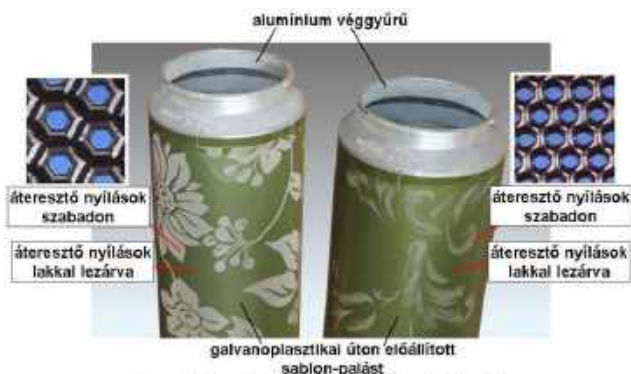
A rotációs filmnyomó-sablon felépítése
