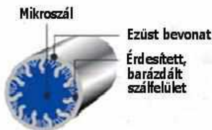
2. ábra. Ezüst nanorészecskékel bevont mikroszál keresztmetszete [6]
