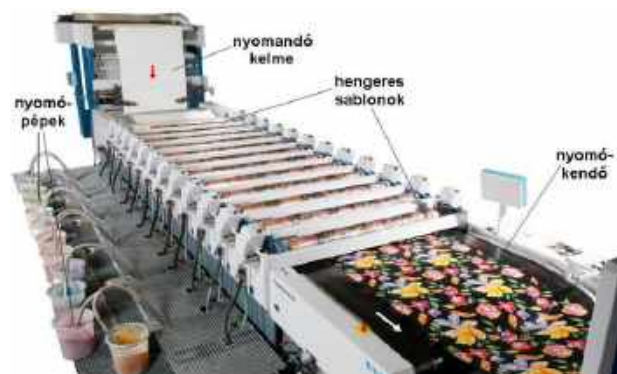
12 színt nyomó rotációs filmnyomógép
