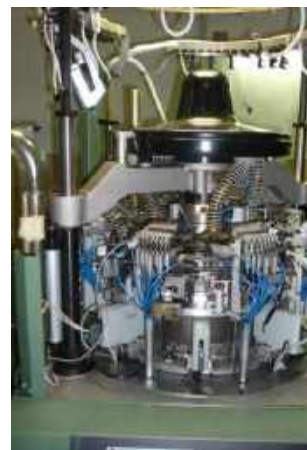
Egybekötött ruhadarab készítésére szolgáló körkötőgép kötőfeje (Santoni)
