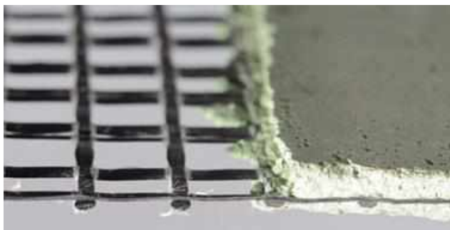
1. ábra. Textilbeton egyrétegű („2D”) textil-vázszerkezettel
