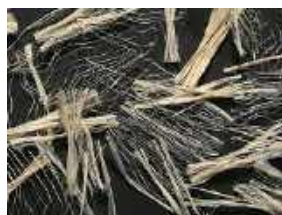
2. ábra. Fibrillált polipropilén-szálak beton-erősítésre
