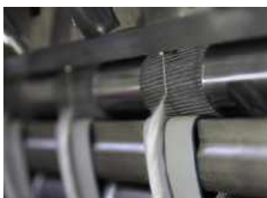
Corizon fonal képzése. Az előfonalat egy filamentfonalra burkolják
