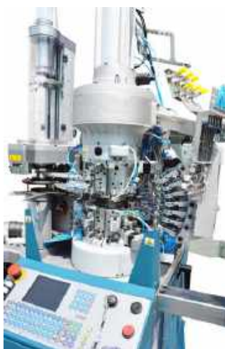
Lonati DC 88 zoknikötőgép automatikus orrhegy- bevarrással
