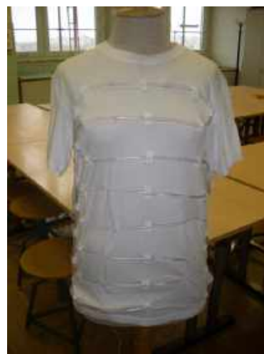
4. ábra. A prototípus képe a felvarrt szilikon csőrendszerrel (Forrás: Szilágyi István)
