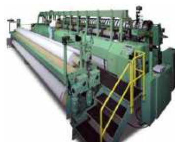
21. ábra. Erősen kiszótt szövetek gyártása széles fogóvetélős szövőgépen
