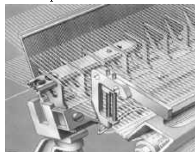
18. ábra. Sulzer-féle vetülékbevitel axonometrikus ábrája, a hajtogató szegély kialakítása
