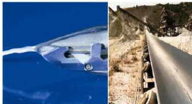
20. ábra. Vastag vetülék bevetése, nagy területi sűrűségű szállítószalag
