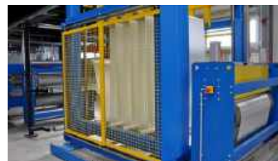
14. ábra. Folyamatos működés megvalósítása puffer-tárolóval [8]
