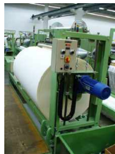
11. ábra. Dörzs- és tengelyhajtás együttes alkalmazása [5]
