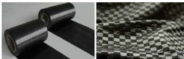
11. ábra. Kiterített szén kábelszalagok és szövés
