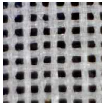
16. ábra. Dreherrel megerősített szűrőszövet
