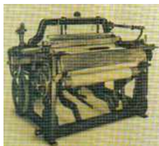
2. ábra. A Rüti cég 1842-ben gyártott vetélős szövőgépe
