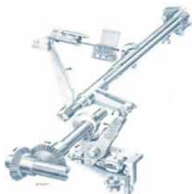
14. ábra. A Sulzer fogóvetelő-szövőgép vetőszerkezete
