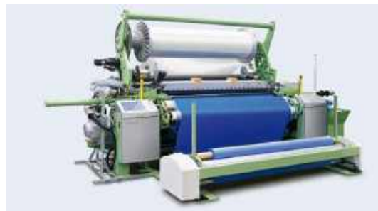
1. ábra. Korszerű kelmefelvétel megoldása szövőgépen
