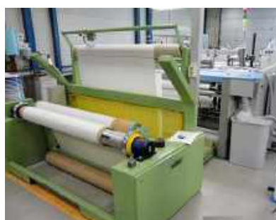
10. ábra. A tekercs pneumatikus adapter befogása és tengelyhajtása [5]
