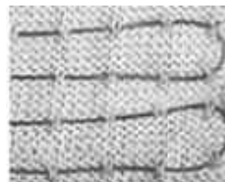
Síkkötött kelmébe befektetett fűtőszál (Stoll)
