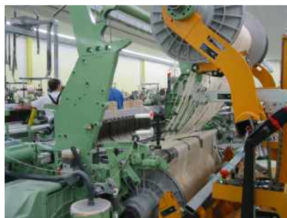
11. ábra. Párhuzamos elrendezésű láncengerek és azok cseréje
