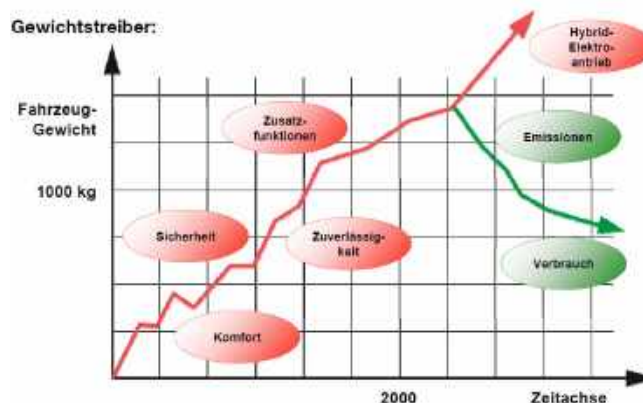
3. ábra. Hibridhajtás hatása az autó tömegnövekedésére, a fajlagos energia-felhasználás csökkentése
