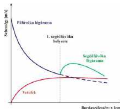
7. ábra. A vetülék sebessége a fő- és az első segédfúvóka légáramának hatásában
