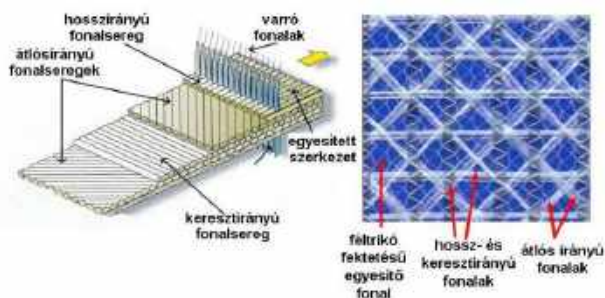
Multiaxiális kompoziterősítő szerkezet felépítése
