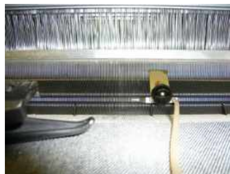
3. ábra. Dornier légsugaras szövőgép segédűvőkái a borda mentén és a vetülécsatornába helyezett Pitot-cső
