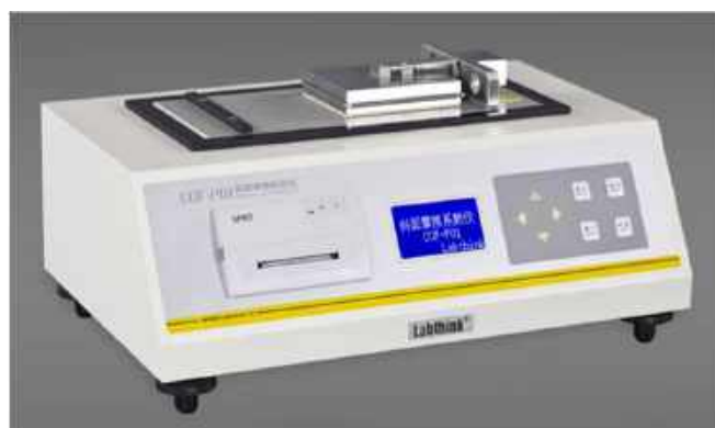
2. ábra. PARAM COF-P01 súrlódásmérő készülék [3]
