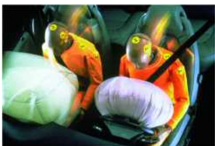
7. ábra. Légzsákok és biztonsági övek tesztelése
