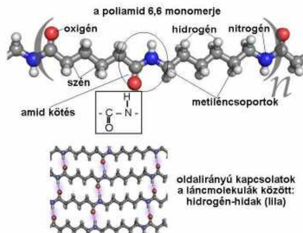
A poliamid 6,6 (Nylon) szerkezete
