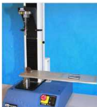
6. ábra. 2810-005 Bluehill® sűrűlődszámoló készülék [7]
