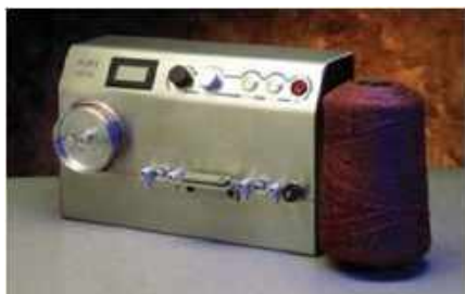
8. ábra. YFM 001 Wira Instrumentation sűrűdasmérő készülék [9]
