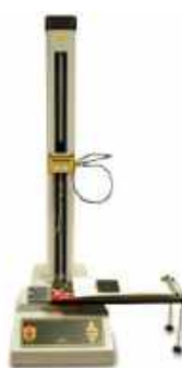
7. ábra. Mecmesin Coefficient of Friction Testers sűrűlődszámoló készülék [8]
