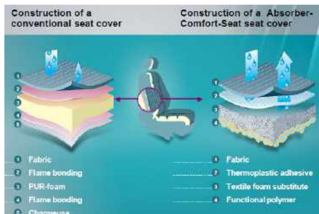
11. ábra. Az ülésbuzat szerkezete
