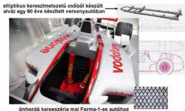
Könnyű és ellenálló szén-szál-erősítésű kompozitból készült karosszéria
