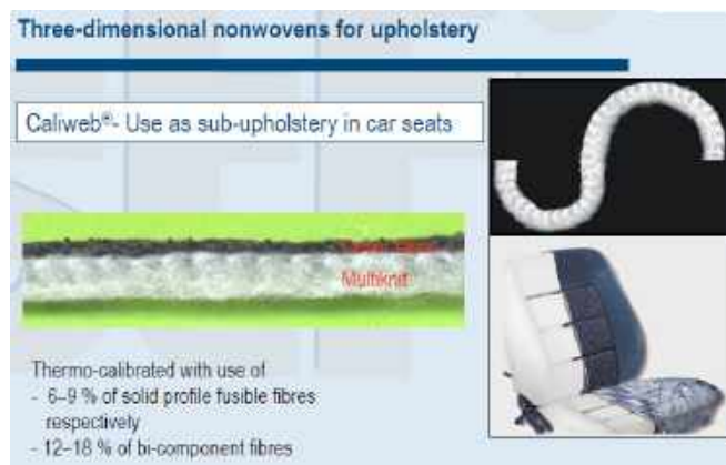
12. ábra Caliweb ülésbuzat szerkezete
