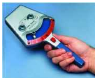
11. ábra. Y096A/B hordozható sűrűdasmérő készülék [12]
