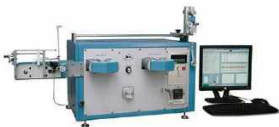
10. ábra. LH-402 CCT sűrűdasmérő készülék [11]
