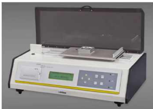
3. ábra. PARAM MXD-02 súrlódásmérő készülék [4]
