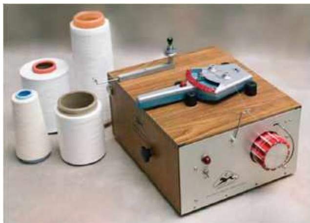
12. ábra. LH 603 YFM Yarn Friction Meter hordozható súrlódásmérő készülék [13]
