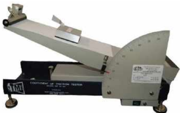
1. ábra. 32-25-00 súrlódásmérő készülék [2]
