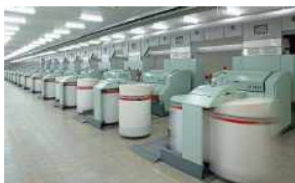
6. ábra. Rieter kártológép
