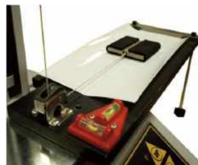
7. ábra. Mecmesin Coefficient of Friction Testers sűrűlődszámoló készülék [8]
