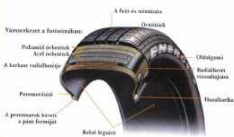
19. ábra. A CableCorder elve, a cérna és az abroncs szerkezete
