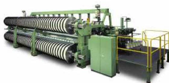
9. ábra. Tárcsás, párhuzamos láncadagolás 8,5 m széles fogóvetéltős szövőgépen
