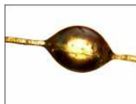
5. ábra. Polipropilén csepp kenderszálon és a cseppléghúzás elve
