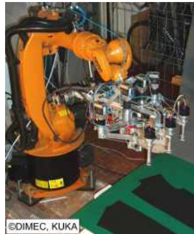
1. ábra. Kiszabott alkatrészek megfogására és áthelyezésére alkalmas robot
