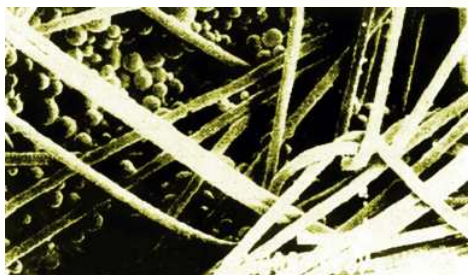
Mikrokapszulázott PCM a textília filamentjei között
